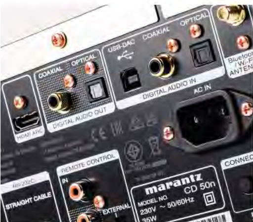
Stopnie analogowe w odtwarzaczu mają, jak zwykle u Marantza, budowę dyskretną. Zestaw wejść cyfrowych jest nieco inny niż w SACD 30n. Duży plus za wejście HDMI ARC.
