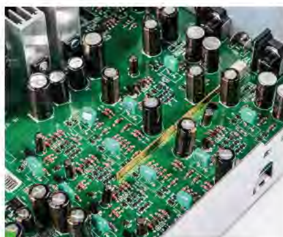
Stopnie analogowe w odtwarzaczu mają, jak zwykle u Marantza, budowę dyskretną. Zestaw wejść cyfrowych jest nieco inny niż w SACD 30n. Duży plus za wejście HDMI ARC.
