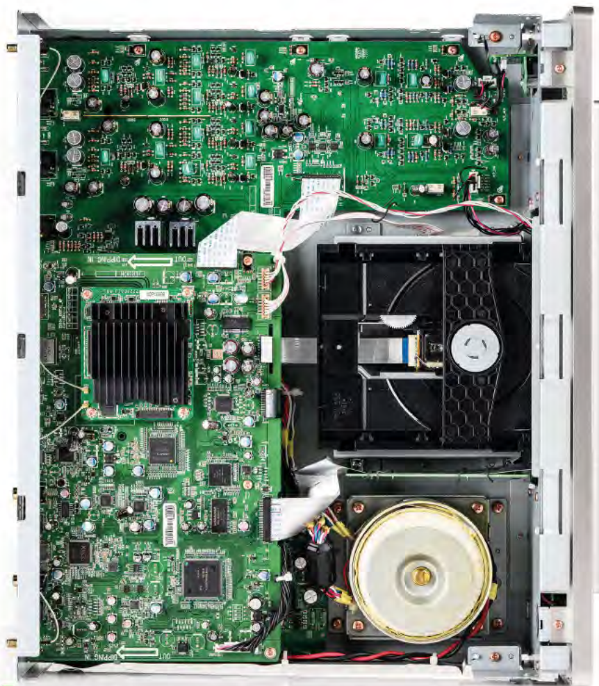
Marantz nie żałował układów elektronicznych także w odtwarzaczu. Elementy zasilacza ukryto pod płytką cyfrową.
